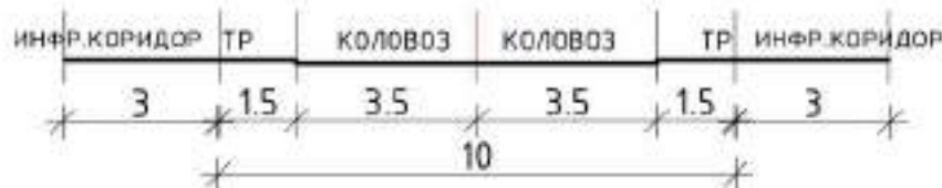
ПОПРЕЧЕН ПРОФИЛ НА НОВОПЛАНИРАНА УЛ.2,3 и 4 - ТИП ИНДУСТРИСКА УЛИЦА, пресек 6-6, 7-7 и 8-8
