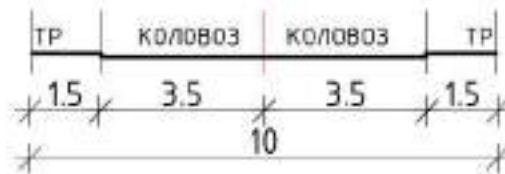
ПОПРЕЧЕН ПРОФИЛ НА НОВОПЛАНИРАНА УЛ.1 - ТИП ИНДУСТРИСКА УЛИЦА, пресек 5-5
